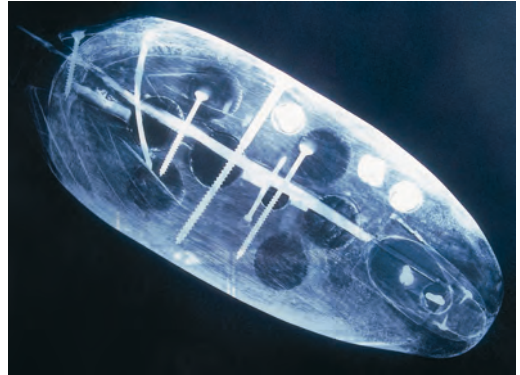
Abb. 124: Röntgenbild von Abb. 122: Bei einer Restaurierung wurden moderne Kreuzschrauben verwendet.
